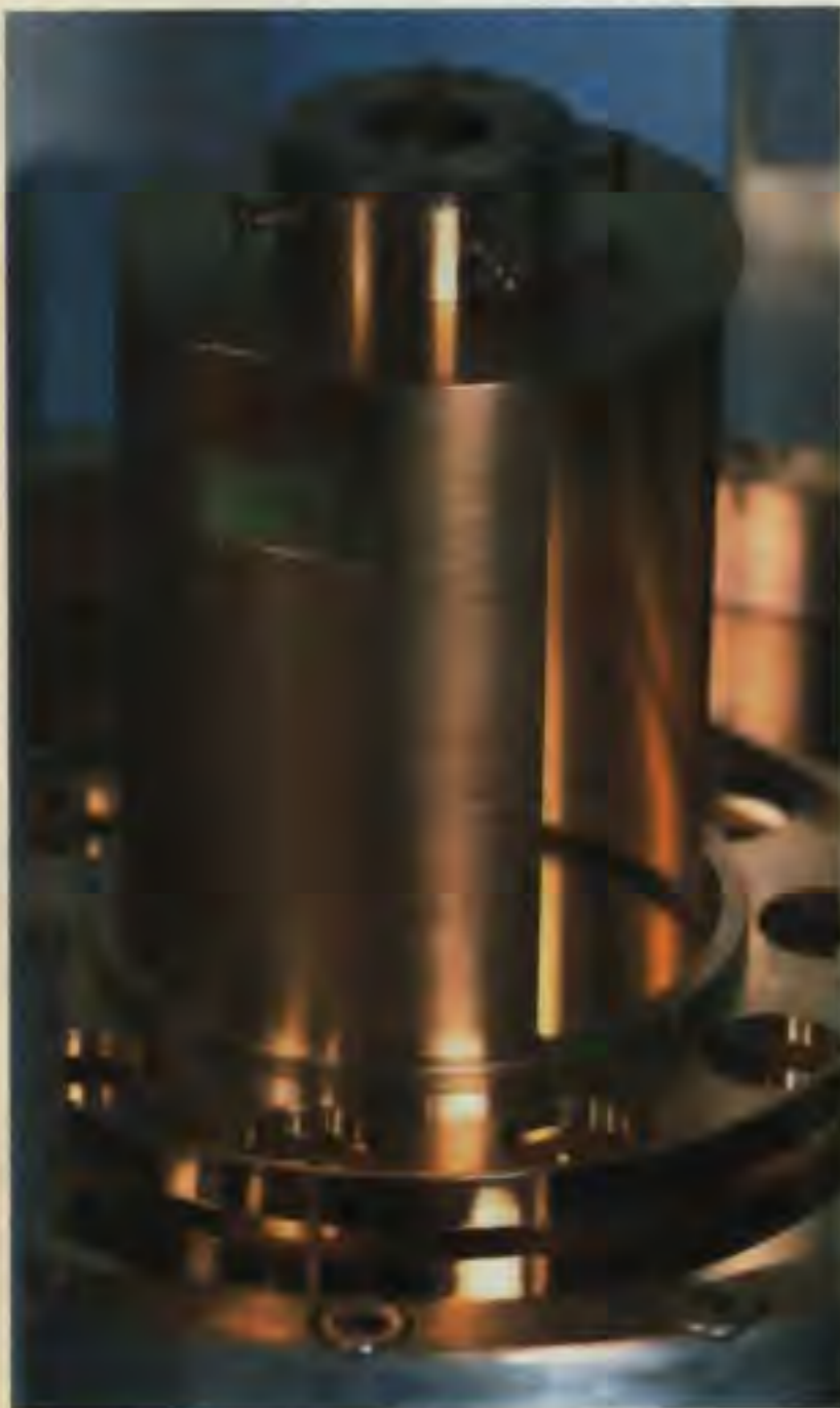
Le groupe Eötvash, de l'université de Washington, mesure l'intensité de l'attraction gravitationnelle à des distances de l'ordre de 0,1 millimètre à l'aide de cette balance de torsion.
